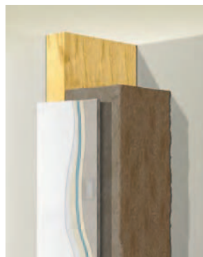
Kiszellőztetett favázis szerkezet
